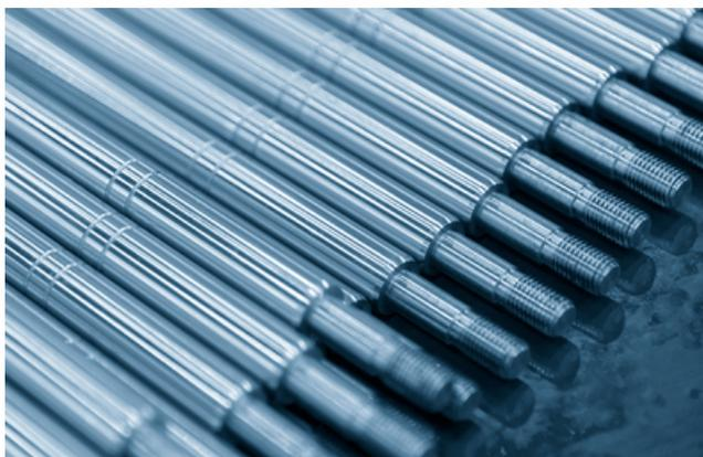
当社が手掛ける硬質クロム・梨地硬質クロム処理サービスの特長の1つが長尺品への対応力です。当社では鉄・SUS製長尺品であれば長さ4,800mm、最大250kgまで、アルミ材であれば長さ700mmまでの対応が可能です。また、アルミ材への硬質クロム処理は、他社が行う処理とは少し異なっており、“ダイレクト”に処理することができます。通常、アルミの表面には酸化被膜が生成されやすいため、亜鉛置換、ニッケルめっき処理を行い、下地をつけてから硬質クロムめっき皮膜を生成します。しかし、当社の工法であれば、直接、硬質クロム被膜の生成が可能です。鉄・SUS系素材の長尺品や、アルミ材へのダイレクト硬質クロム処理はお任せください。
